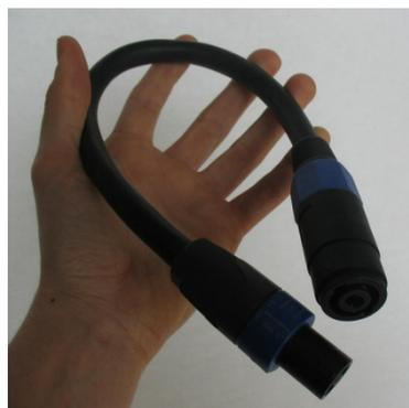
Figura 6: Cavo adattatore per JA12
