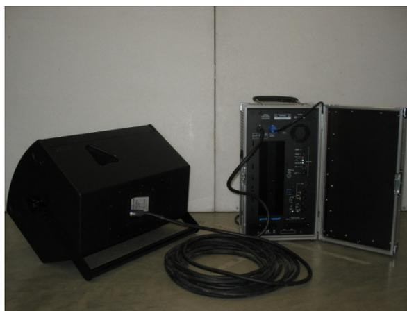
Figura 9: Collegamenti per la sorgente direzionale *JA4012*. PRESET: "*JA40*"
