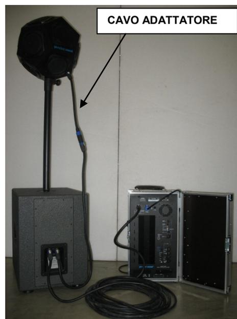
Figura 7: Collegamenti per l'amplificazione del solo *JA12*. PRESET: "*JA12*"
