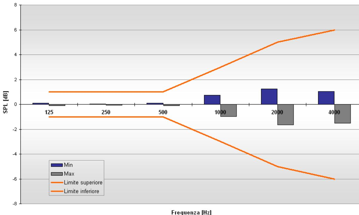
**Esito della prova:** la sorgente sonora Peecker Sound JA12 è conforme alle prescrizioni minime di omnidirezionalità secondo la norma UNI EN ISO 3382:2001.
